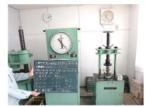
工種: 断面修復工·壁高欄補修工 内容: 定期管理試験(圧縮強度) 規格値: 設計基準強度40N以上
