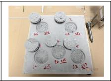
工種: 断面修復工・壁高欄補修工 内容: 定期管理試験(付着性) 規格値: コンクリートとの付着性1.5N/mm以上
